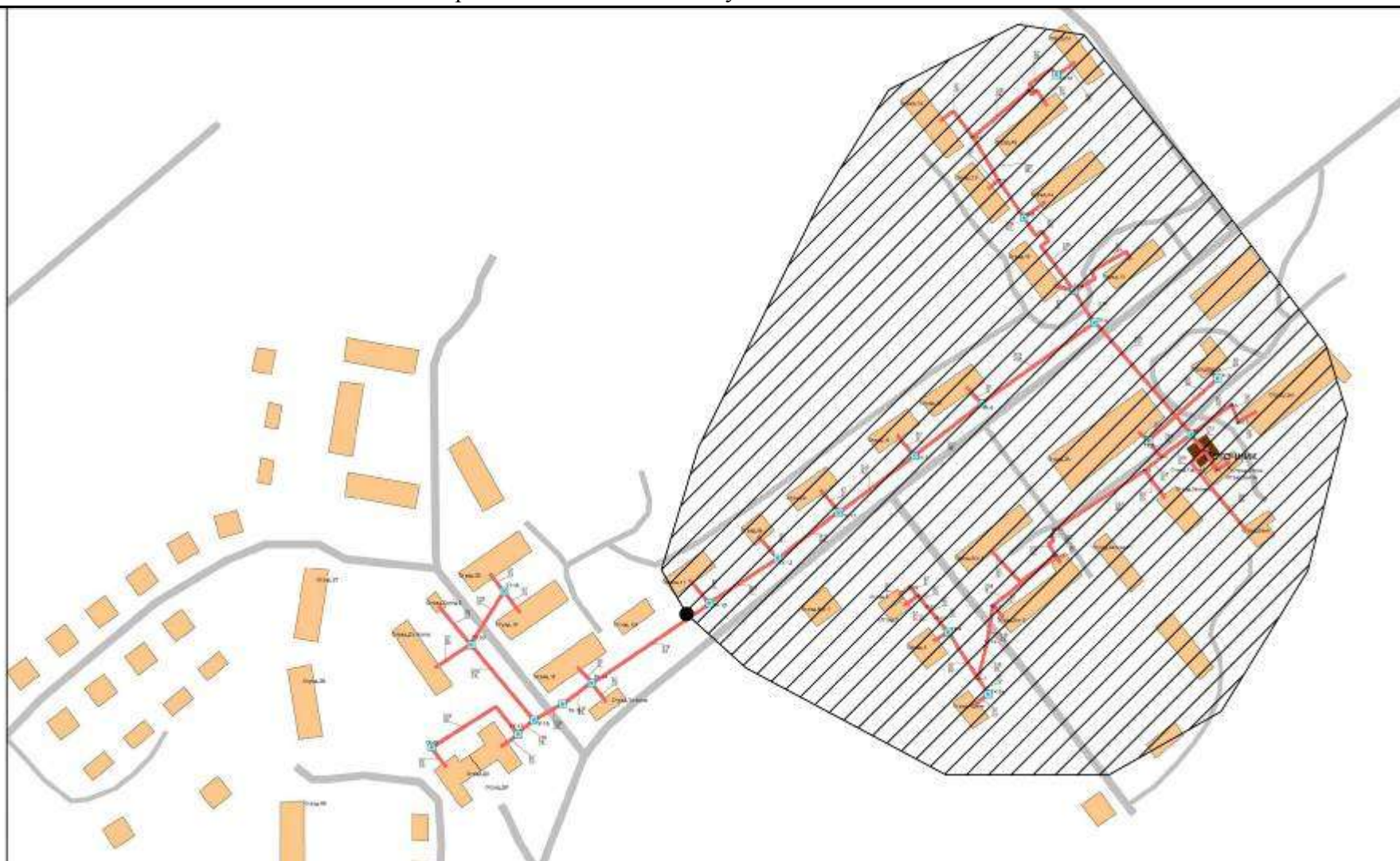
Рис. 6. Зона эффективного теплоснабжения для котельной п. Отрадный
